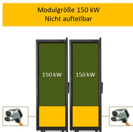
**Abbildung 57: Modulares System 2 x 1 x 150 kW**
